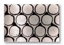
φίλτρων βαθιάς διήθησης. Για να προβλεφθεί ο ρυθμός κατακράτησης σωματιδίων στα φίλτρα, πρέπει να μελετηθεί το φαινόμενο από τη μικροκλίμακα του πόρου, λαμβάνοντας υπόψη τα πεδία δυνάμεων που επηρεάζουν την τροχιά του σωματιδίου και τις επιφανειακές δυνάμεις που είναι υπεύθυνες για την κατακράτηση των σωματιδίων πάνω στους κόκκους του πληρωτικού υλικού,
